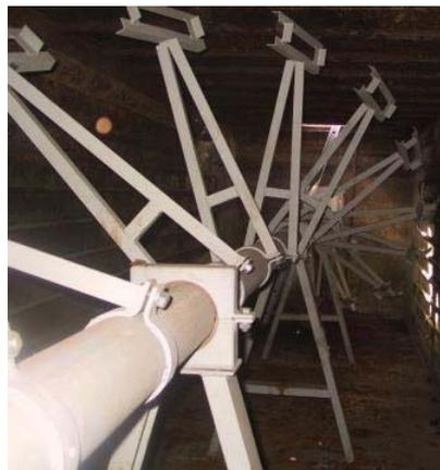
**Abbildung 15: Langachs-Paddelrührwerk im leeren Versuchsfermenter**
