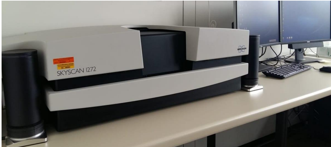
Abbildung 4: Mikro-CT SkyScan 1272 und zugehöriger Bildschirmarbeitsplatz
