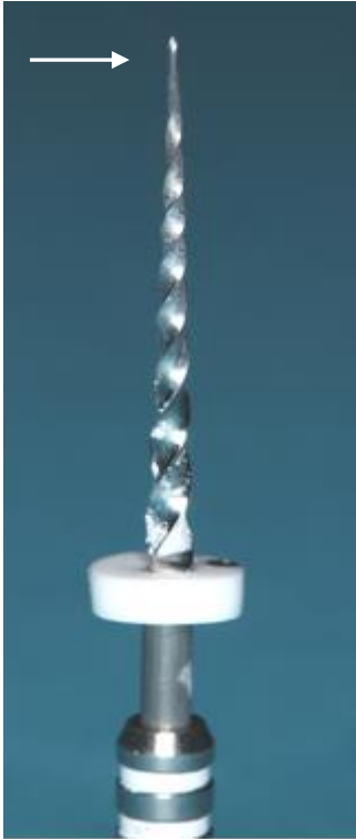
Abbildung 19: Deformiertes Instrument D3
