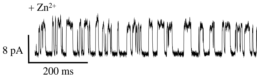
Abb. 4-61: Stromsignal einer Membran (DPhPC/Cholesterin 9:1) in Anwesenheit von 1,7 \mu\text{M} DCD, gemessen in 1 M NaCl, 2 mM ZnCl_2 , 5 mM HEPES, \text{pH} 7,1 ), bei einer Transmembranspannung von U_m = 100 \text{ mV} .
