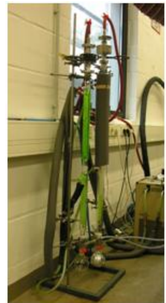
Abbildungen 5 und 6: Foto und schematische Darstellung der Probenahme gemäß der VDI-Richtlinie 3872 Blatt 1.
