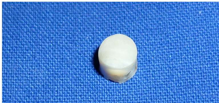
Abb. 3.4 Schmelz-Dentin-Probe mit einem Durchmesser von 5mm
