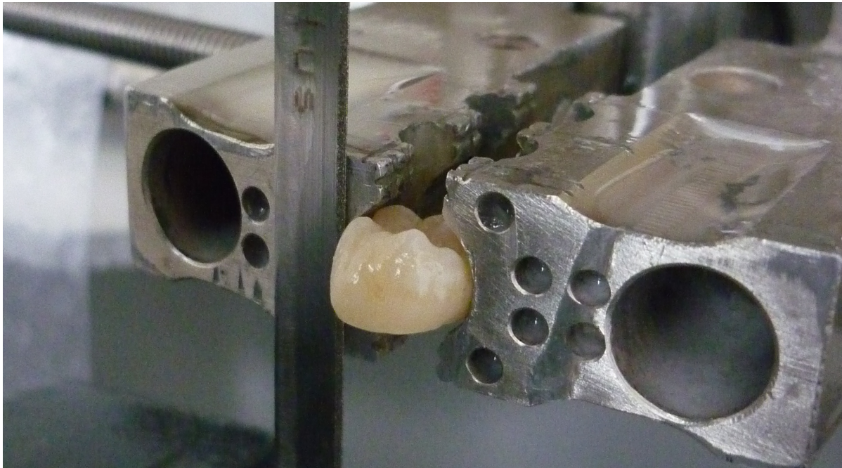
Abb. 3.2 Separierung der Zahnkrone in mesio-distaler Richtung mit Hilfe des Trennschleifgerätes
