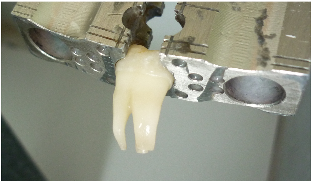
Abb. 3.1 Abtrennung der Wurzeln von der Zahnkrone durch ein Trennschleifgerät
