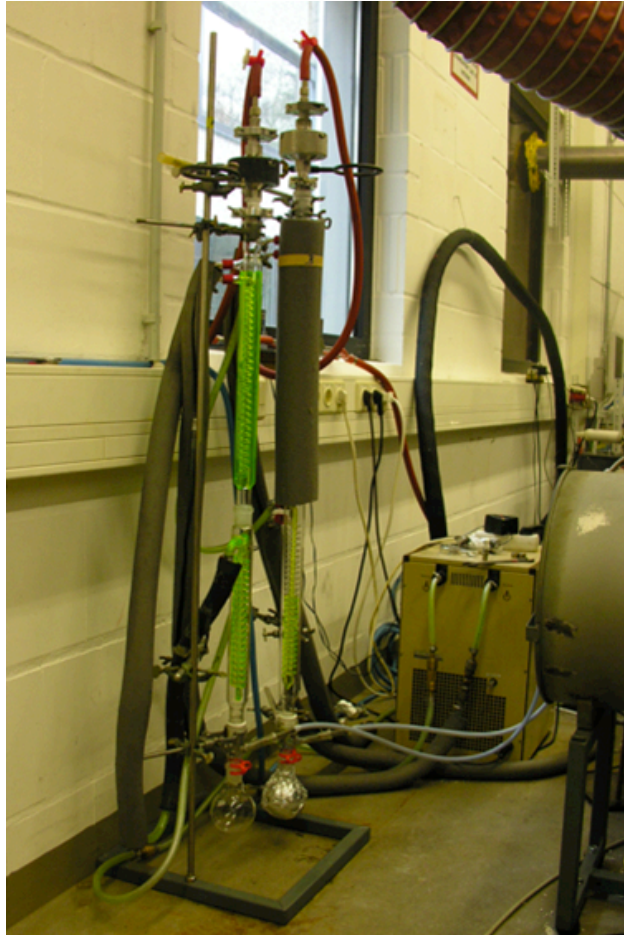
Abbildung 4: Apparatur zur Probengewinnung im Johann Heinrich von Thünen-Institut (vTI), Braunschweig
