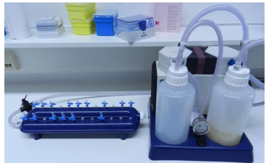
Abbildung 3.3: QiaVac-System. Die Vakuumpumpe (rechts) baut das Vakuum für den Probenständer (links) auf.
