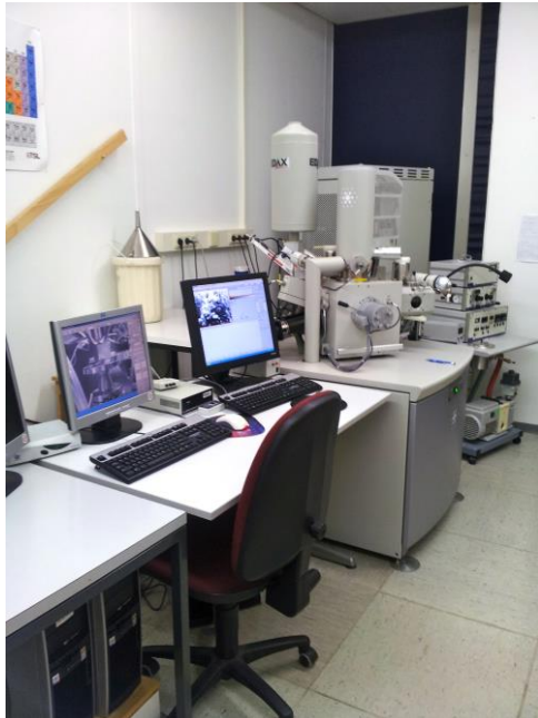
Abb.17: Rasterelektronenmikroskop (REM) der Baureihe Quanta 200 von FEI (FEI, Hillsboro, Oregon USA) mit Elektronensäule, Geowissenschaftliches Zentrum Universität Göttingen, Abt. Kristallographie
