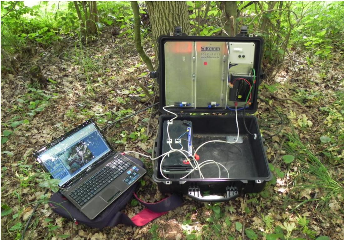
**Abbildung 39** Technik zur Überwachung und Aufzeichnung der Videos an den Nestern, die mit Kameras beobachtet wurden (Pelikkoffer mit Bleigelakku, Videojet, externe Festplatte und Laptop zur Überprüfung und Einstellung der Aufzeichnungen).
