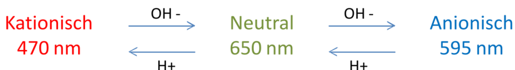
Abb. 2.2: Reaktionsgleichung für die Proteinbestimmung nach Bradford
