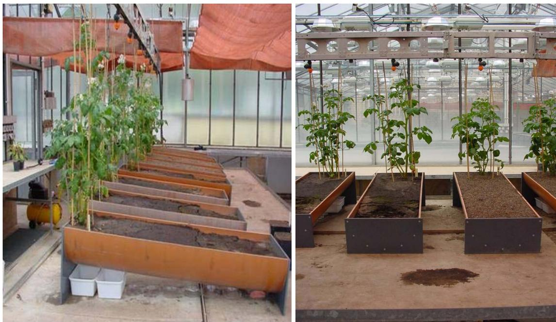
**Abbildung 13: Rinnenversuche im Gewächshaus.** Die Knollen wurden am oberen Ende einer schräg aufgestellten, 1 m langen Rinne gepflanzt. In der Rinne befinden sich alle 10 cm Löcher zum Ablauf des Gieswassers. Unter diesen Löchern sind Behälter aufgestellt, die das Durchlaufwasser auffangen. Dieses Wasser wird anschließend mikroskopisch auf *H. solani* Konidien untersucht.
