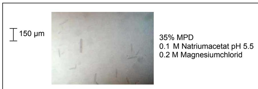
Im Fall des 90k-His wurde nach 2 Wochen ein Ansatz gefunden, in dem sich ein Kristall gebildet hatte (Abb. 56). Nach der Messung mit Hilfe eines Röntgendiffraktometers stellte sich heraus, dass es sich hierbei um einen Salzkristall
