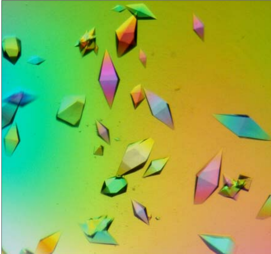
Abb. 42: AmyB-Tm-Kristalle in 4 M Na-Formiat, 5 % Isopropanol und 2 mM DTT, betrachtet durch einen Polfilter vor dem Objektiv des Stereomikroskops.
