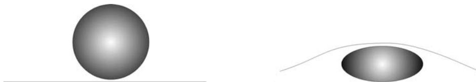
**Abbildung 4.4 Schematische Darstellung der Abflachung von Partikeln bei der Sandwich-Präparation**
