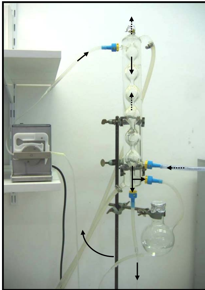
Abb. 6: Perfusionsapparatur. Die Flussrichtung des Perfusionspuffers ist mit durchgehenden Pfeilen, der Gasstrom mit unterbrochenen Pfeilen markiert. Der Puffer wird im Oxygenator begast und auf 37°C temperiert, bevor er zur Leberperfusion abfließt. Überschüssiger Puffer wird zurück in den Vorratskolben und erneut durch den Oxygenator geleitet.
