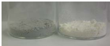
Abbildung 11.1.6.1: Polynorbornen hergestellt mit Palladiumkomplex (links) und Nickelkomplex (rechts).
