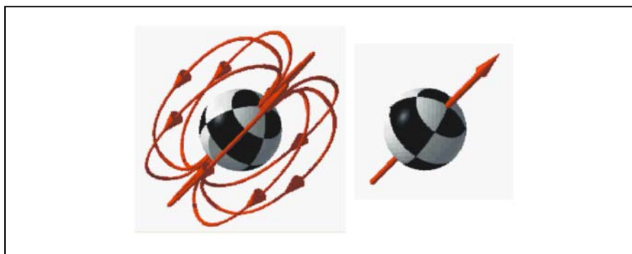
Abb.I: Der Drehimpuls eines Atomkerns erzeugt ein Magnetfeld. Durch die Drehung des Kerns entstehen zwei Pole: Nord- und Südpol. Die Magnetisierung wird durch Pfeile dargestellt, wobei die Pfeilspitze in Richtung des Nordpols weist (Abbildung durch T. Wüstenberg)
