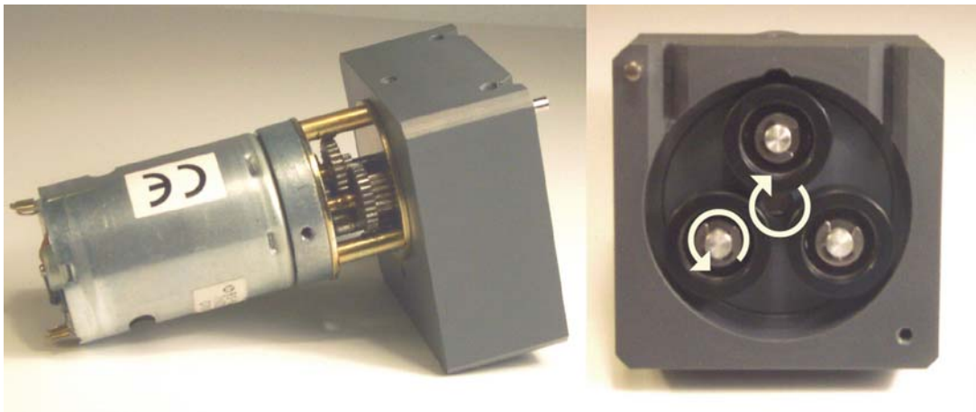
Abbildung 10: Die Pumpe ohne Gehäuse. Pumpenkopf und die Drehrichtungen der Andruckrollen.
