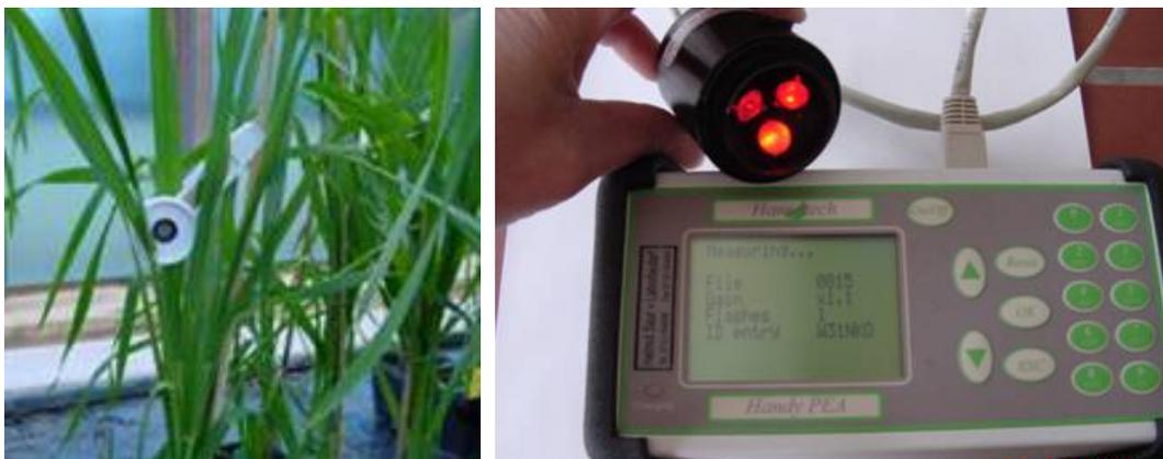
Abbildung 7: Blattclips zur Abdunklung von Blattabschnitten (links) und das HandyPea-Gerät (rechts) mit konstantem, aktinischem, gesättigtem Licht während 1 Sekunde aus 3 x 650 nm LED's, maximale Intensität von  $3500 \mu\text{mol m}^{-2} \text{s}^{-1}$ .
