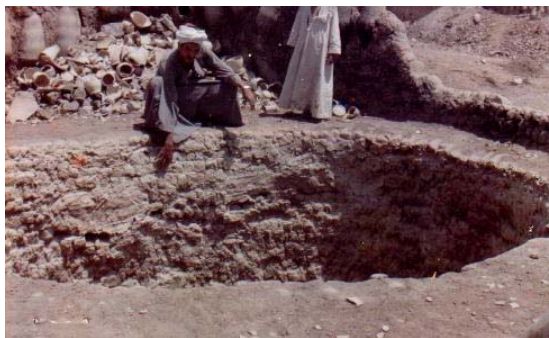
In den Boden gegrabener Brennofen, der mit Holz und Dung befeuert wird
