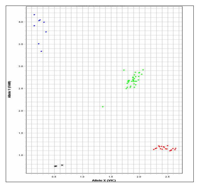
Abbildung 6: Genotypisierung von MDR1 Ile1144Ile mittels Allel-diskriminierender TaqMan®-PCR unten rechts: Variante (VIC), oben links: Wildtyp (FAM), in der Mitte: Heterozygote Träger (Both), unten links: nicht detektiert)
