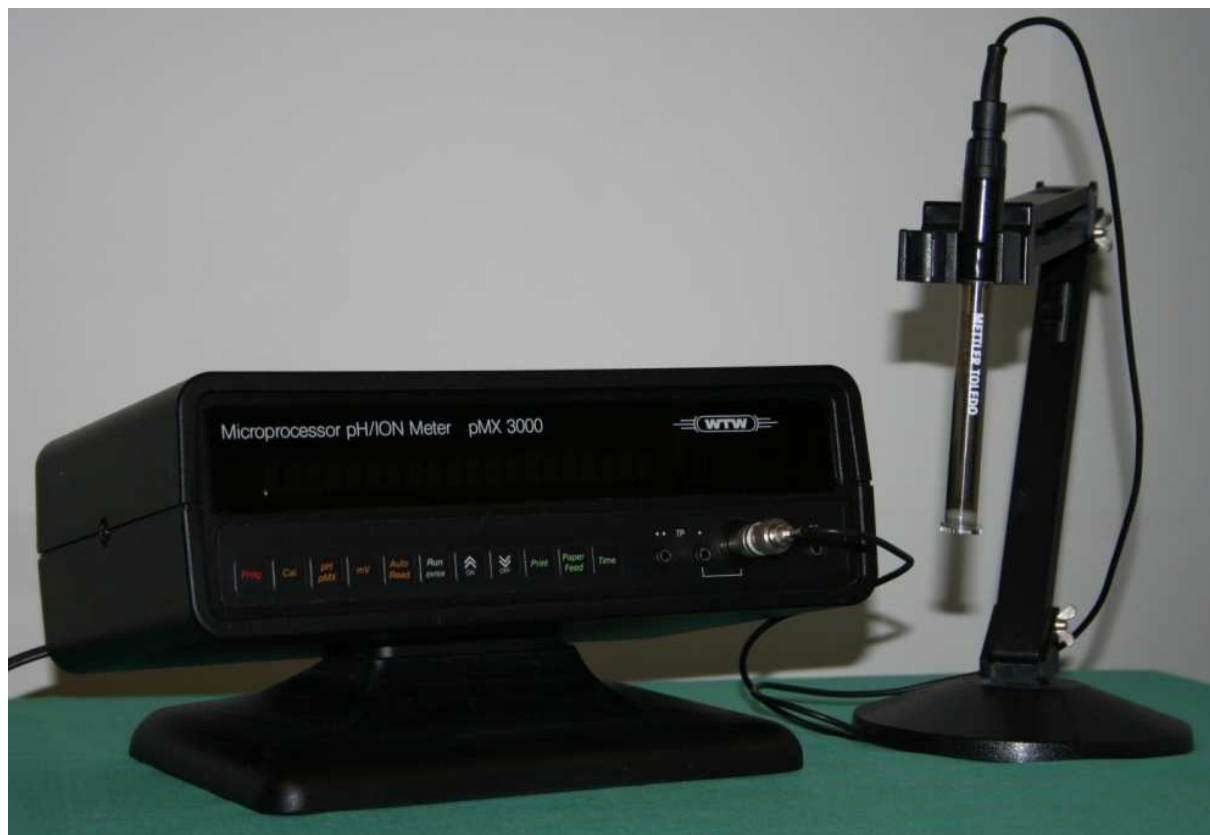
Abb. 7 Messplatz mit Fluoridmesselektrode und angeschlossenem Spannungsmessgerät.
