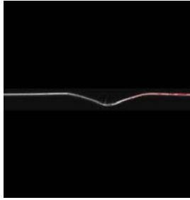
Abb. 64: vertikaler Schnitt durch die Probe von B2 vor der Impression.
