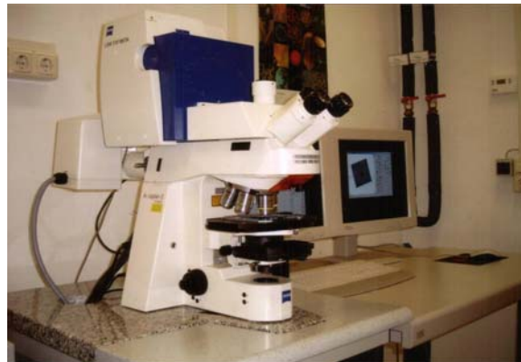
Abb.13: Laser Scanning Mikroskop (LSM) Meta 510 der Firma Carl Zeiss Jena
