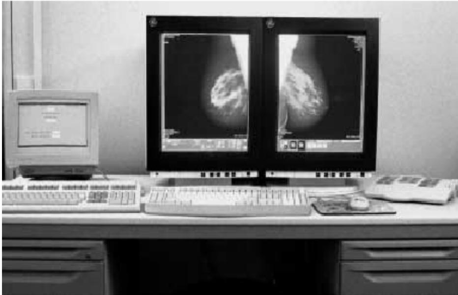
**Abbildung 3: Mammographie Workstation mit zwei hochauflösenden Monitoren (2000×2500 Pixel) für die Befundung. Zusätzlich abgebildet ist ein Computer zur Bedienung des radiologischen Informationssystems.**
