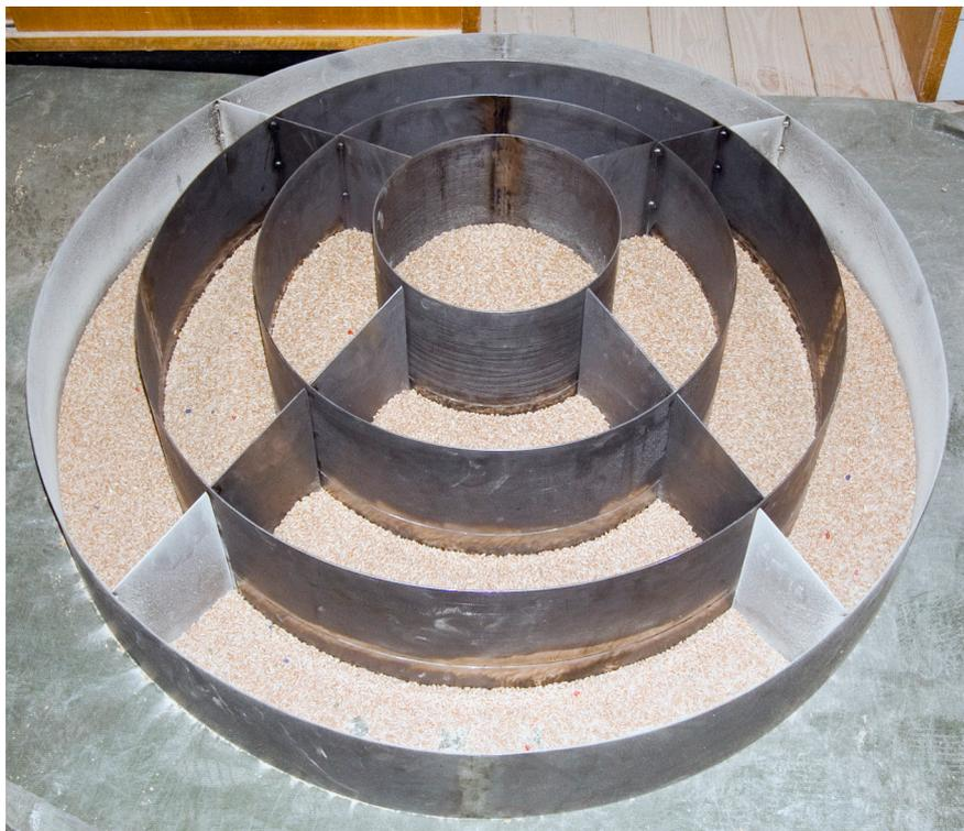
Abbildung 23: Eingestochener Probenteiler im Schüttkegel
