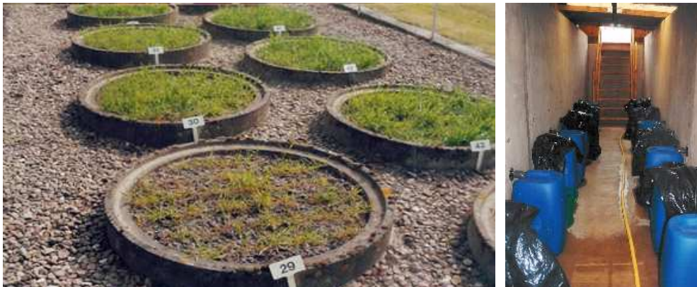
Abbildung 11: Mit Winterroggen bestellte Lysimeter und Lysimetergang mit Sickerwasserauffangbehältern
