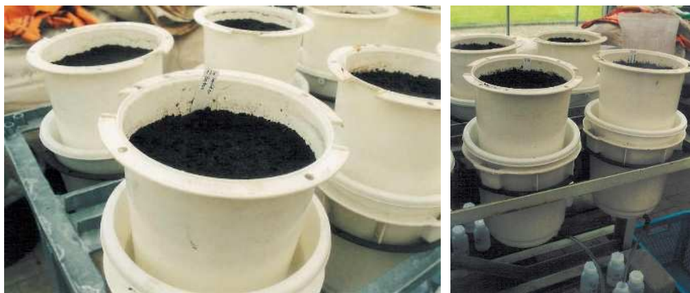
Abbildung 10: Kick-Brauckmann-Gefäße und Beprobungsvorrichtung zum Auffangen der Sickerwasserfraktionen
