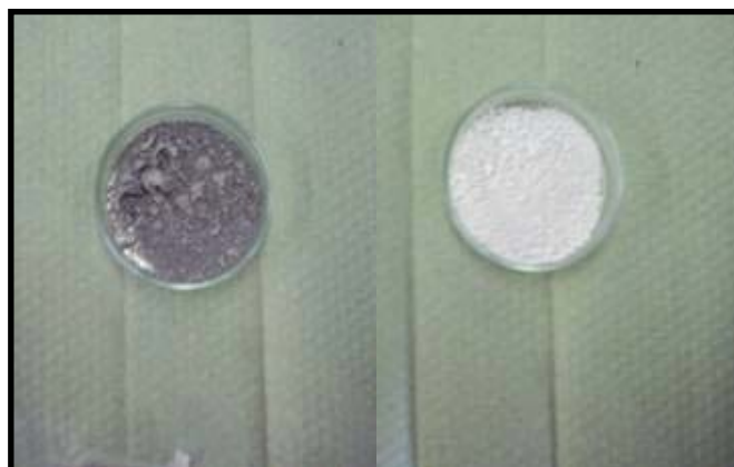
Abbildung 66: Unter Verwendung von Komplex 10a . hergestelltes Polyethylen. Ohne Temperatursteuerung (links) und mit Konstanthaltung der Temperatur [18 °C] (rechts).
