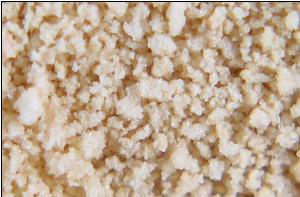
**Abb. 4-17:** Struktur der mechanisch-enzymatisch aufgeschlossenen Kartoffelpülpe nach der Wirbelschicht-Sprühgranulation
