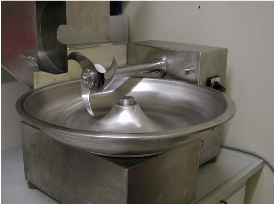
**Abb. 3-1:** Tischcutter für den mechanischen Aufschluss der Kartoffelpülpe
