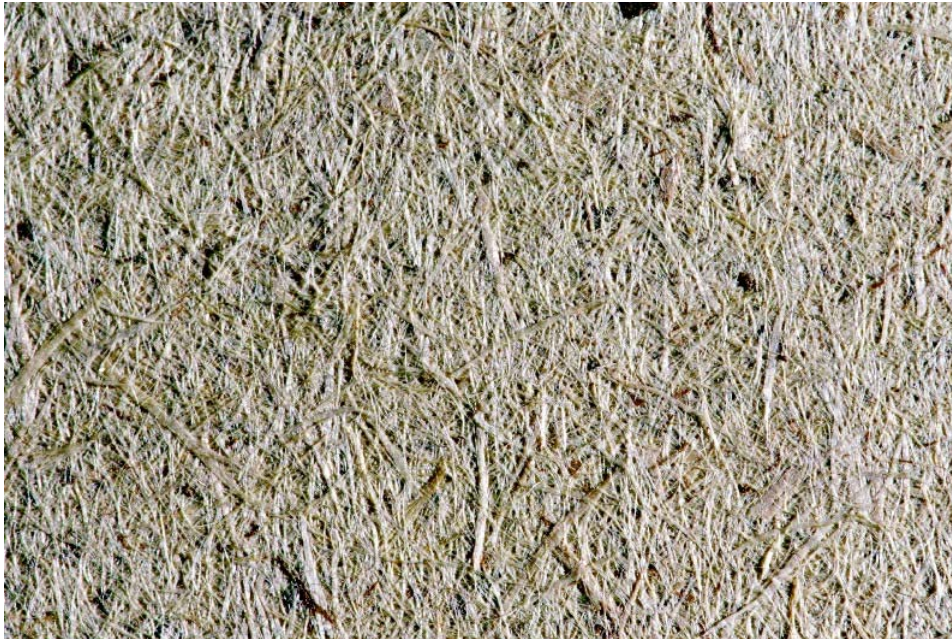
Abbildung 4-2: RAPID-KÖTHEN-Blattbildner aus STEICO-Faserstoff, Nahaufnahme
