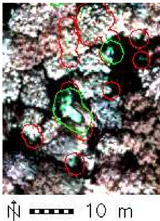
Abb. 3.14: Ausschnitt aus einem digitalen Farbinfrarot-Orthofoto mit abgestorbenen Bäumen (stehendes Totholz, grüne Vektoren) und abgestorbenen Ästen innerhalb lebender Baumkronen (rote Vektoren) als Ergebnis eines Schwellenwertverfahrens
