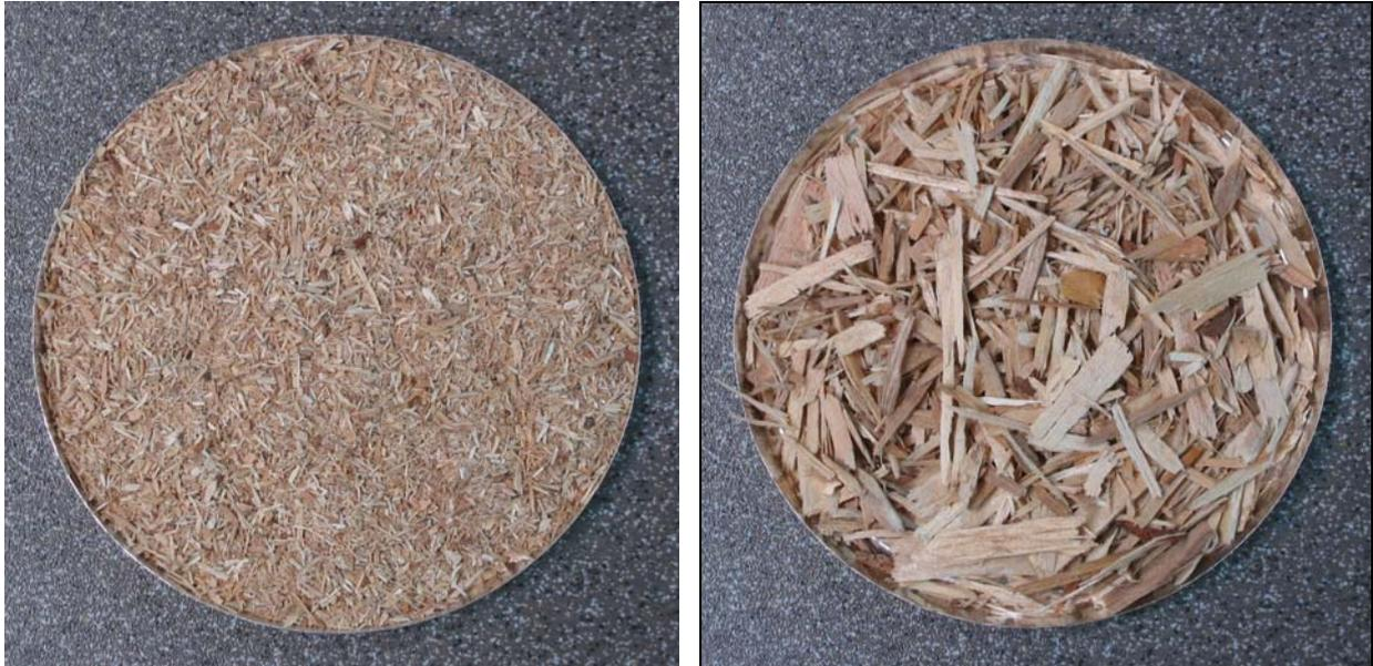
*Bild 3-3: Deckschichtspäne (links) und Mittelschichtspäne (rechts) aus dem Spanplattenwerk Gütersloh (Foto: BOHN, 2004)*
