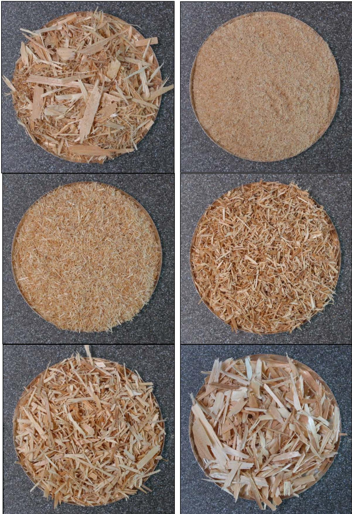
Bild 3-4: Siebanalyse: Spanmaterial aus rotfauler Fichte; ungesiebt (o. li.), nach Siebanalyse in den Fraktionen: o. re. < 0,6 mm; Mitte li. < 1,25 mm; Mitte re. < 3,15 mm; u. li. < 5,0 mm; u. re. > 5,0 mm (Foto: BOHN, 2004)
