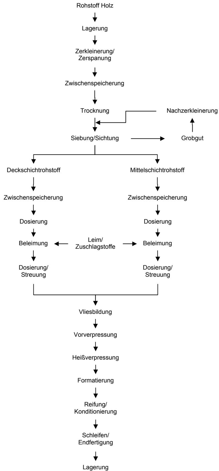
Abbildung 2-8: Fertigungsablauf für Spanplatten nach dem kontinuierlichen Flachpressverfahren
