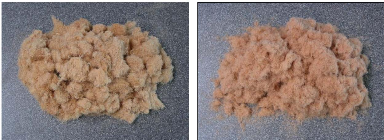
*Bild 3-5: Faserstoff aus rotfaulem Fichtenholz, nativ und aufgelockert (li.); Faserstoff der Firma STEICO (re.), nativ und aufgelockert (Foto: BOHN, 2004)*
