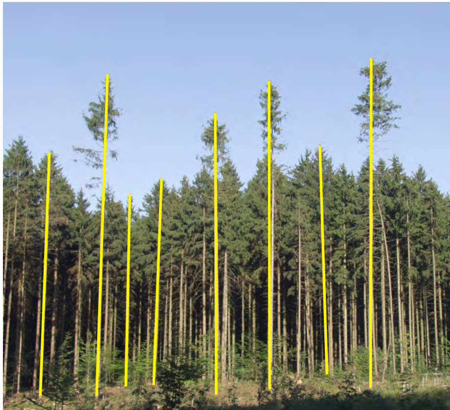
Abbildung 4-18: Für gut sichtbare Bäume wurden die Baumspitzen und Stammfußpunkte in Bildkoordinaten ermittelt und die relativen Neigungswinkel im Bild bestimmt.
