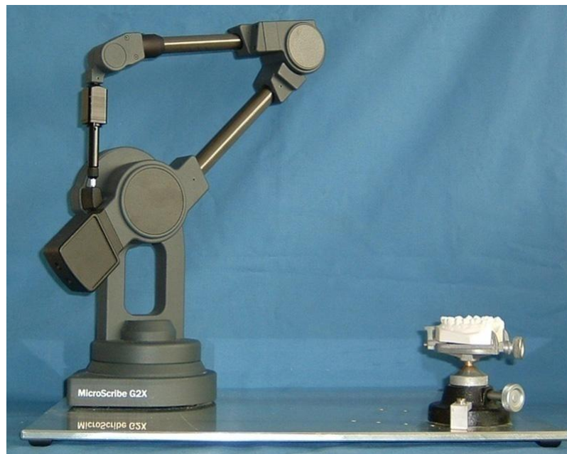
Abb. 21 3D-Digitizer „MicroScribe G2X“ und Modelltisch auf einer Platte montiert
