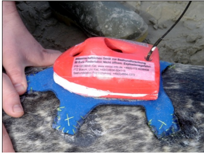
Abbildung 4.1-2: Satellitensender wird auf dem Rücken eines Seehunds fixiert (Quelle: BORCHARDT, Vortrag 2006, Nationalparkamt Tönning, S.-H.)
