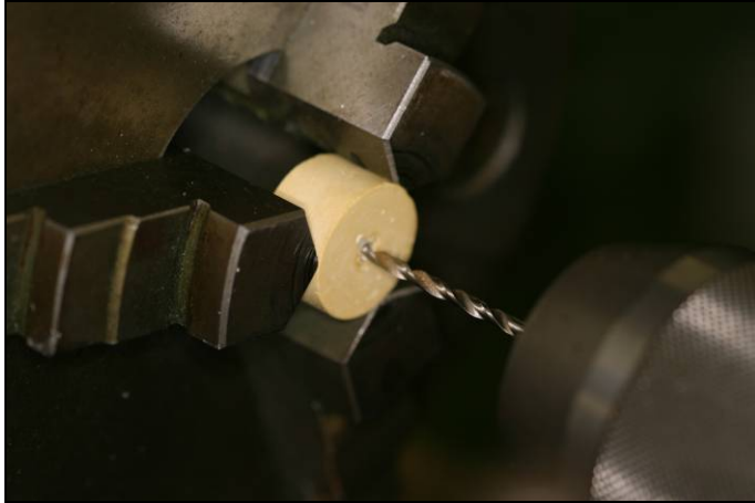
Abbildung 5 Anlegen der Normbohrung an der Unterseite des im Gips fixierten Messzahnes
