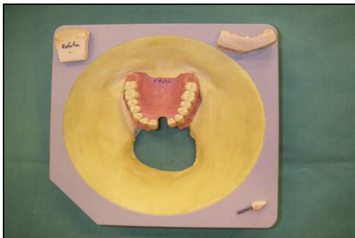
Abbildung 7 Messteller mit Messzahn und Repositionierungsschlüssel
