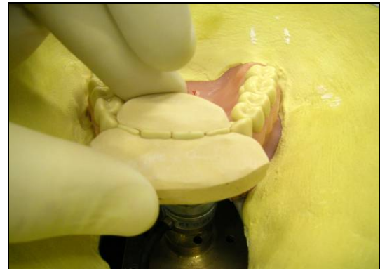
Abbildung 10 Reproduzierbare Fixierung des Messzahnes mittels Gipsschlüssel
