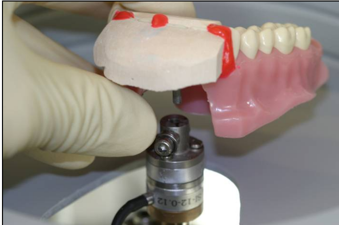
Abbildung 6 Der Stahlstift des fixierten Messzahnes wird in die Klemmvorrichtung eingeführt
