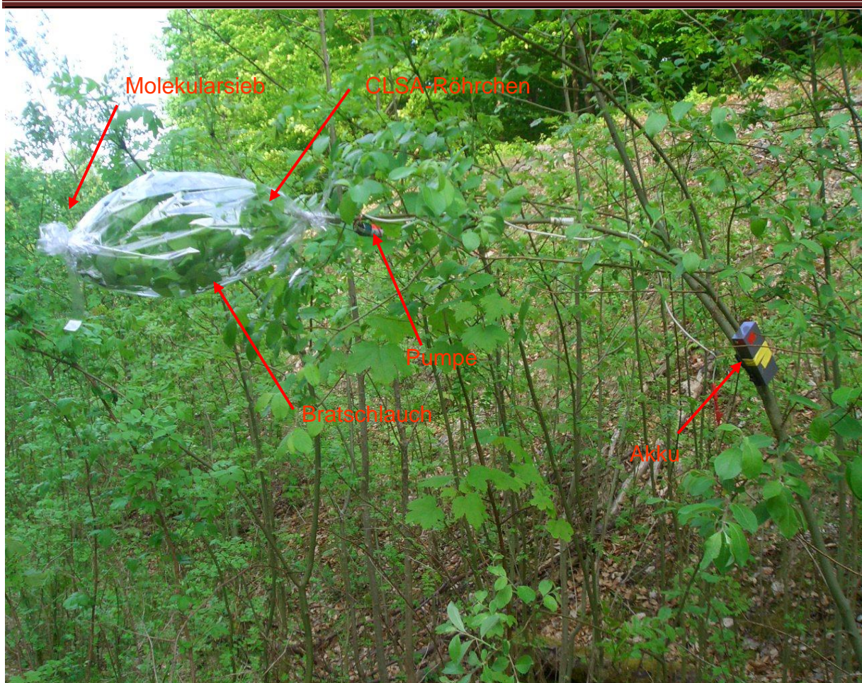
Abbildung 2.4. Duftprobennahme an einer Salweide im Freiland.
