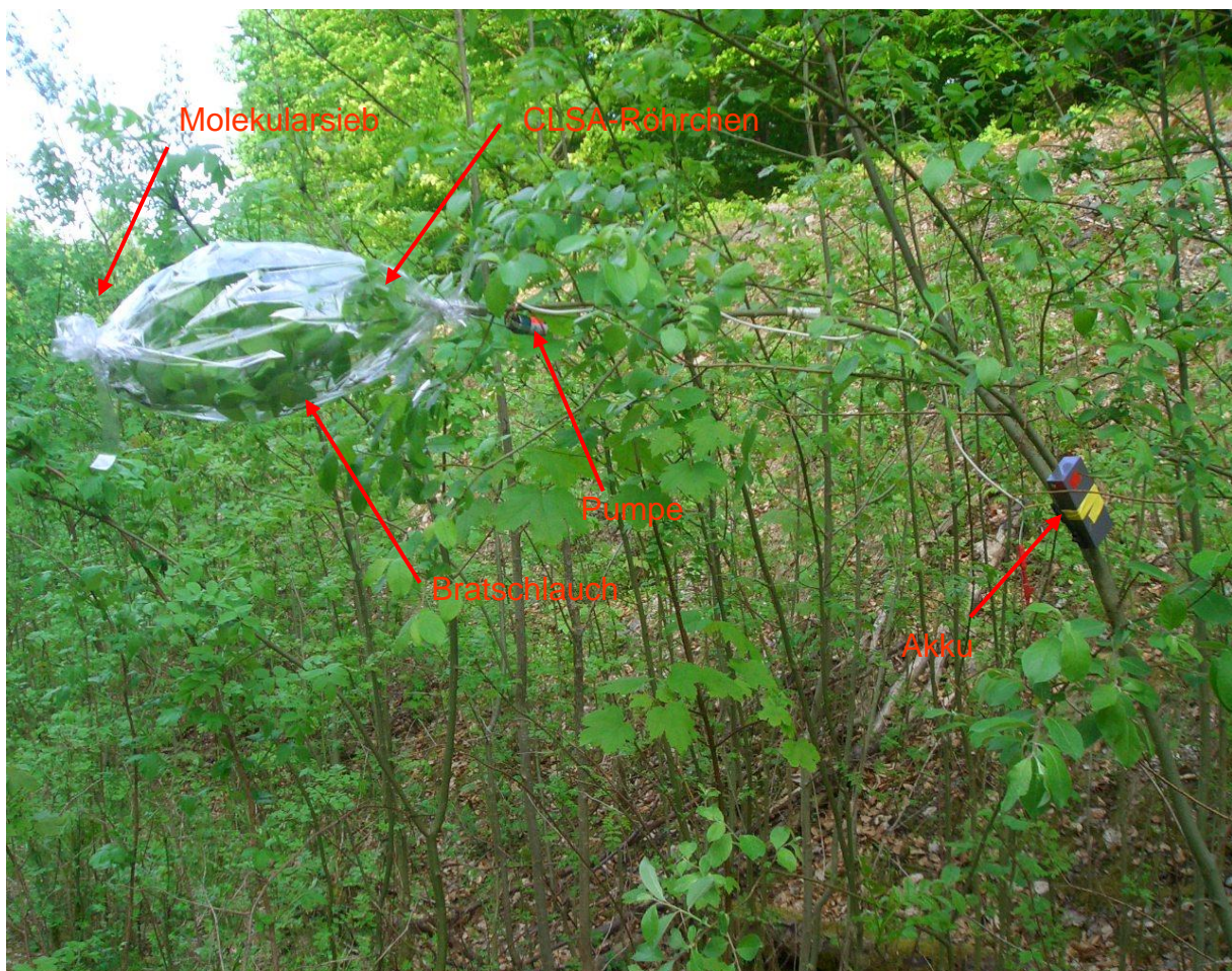
Abbildung 2.4. Duftprobennahme an einer Salweide im Freiland.
