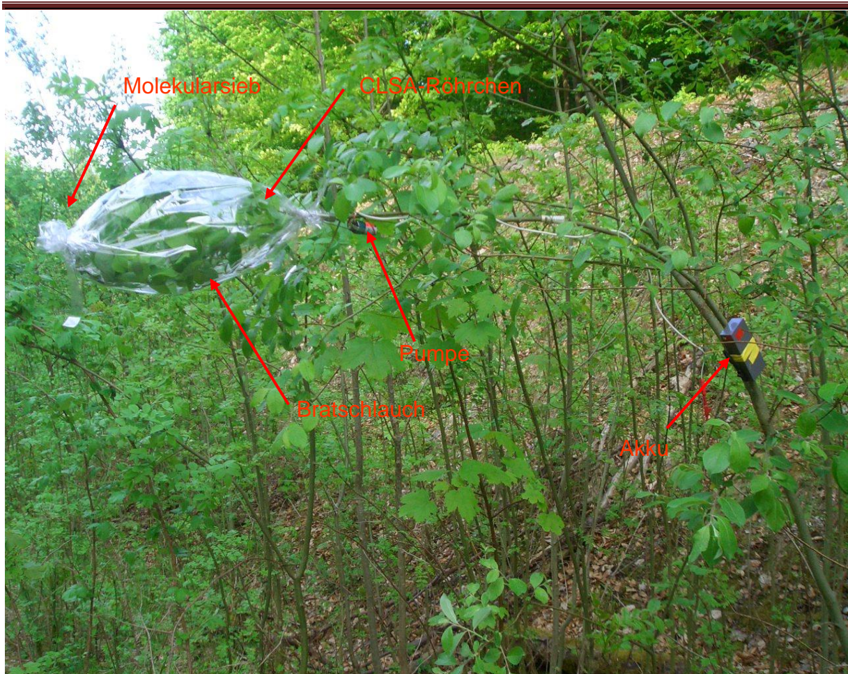
Abbildung 2.4. Duftprobennahme an einer Salweide im Freiland.
