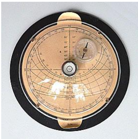
Abbildung 2.1. Horizontoskop der für die Bestimmung der potenziellen Sonnenscheindauer benutzt wurde. Photoquelle: http://www.waldwissen.net/themen/waldbau/wsl_horizontoskop_DE
