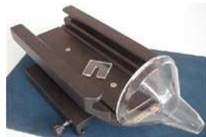
Abb. 3: links: pQCT-Gerät (XCT Research SA) (Quelle: http://www.stratec-med.com/en/layout/prod_xctrsa.jpg ) rechts: Vorrichtung zur Fixation des Rattenhinterlaufes (Quelle: http://www.stratec-med.com/en/layout/rattenhalter.jpg )
