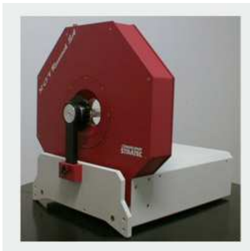
Abb. 3: links: pQCT-Gerät (XCT Research SA) (Quelle: http://www.stratec-med.com/en/layout/prod_xctrsa.jpg ) rechts: Vorrichtung zur Fixation des Rattenhinterlaufes (Quelle: http://www.stratec-med.com/en/layout/rattenhalter.jpg )
