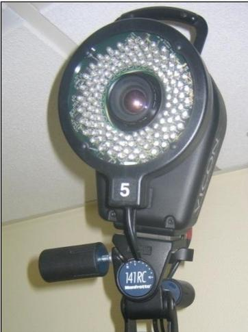
Abb. 12: Kamerasystem mit rund um das Objektiv angeordneten LED-Elementen
