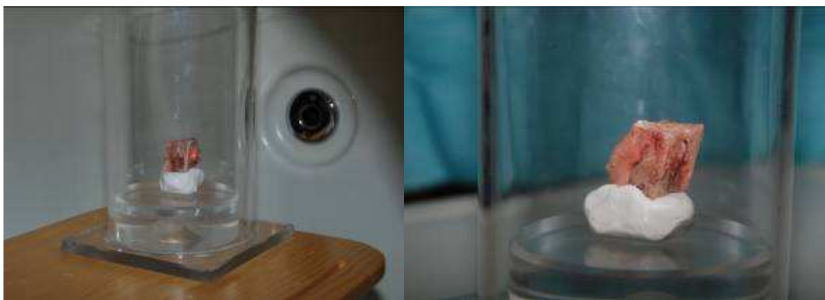
Abb. 7: Positionierung des Schweinekieferblockes in der Plexiglasröhre, Positionierung im DVT (zu fotografischen Zwecken Darstellung ohne Leitungswasser).
