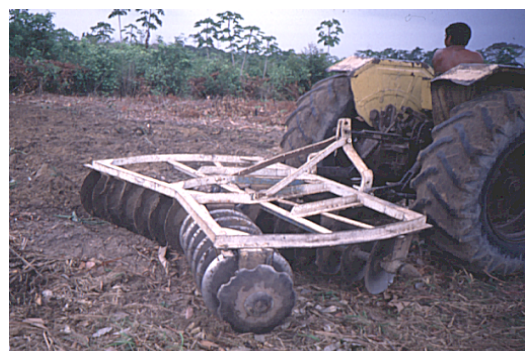
Abbildung 7: Einsatz der Scheibenegge bei der Flächenbehandlung
