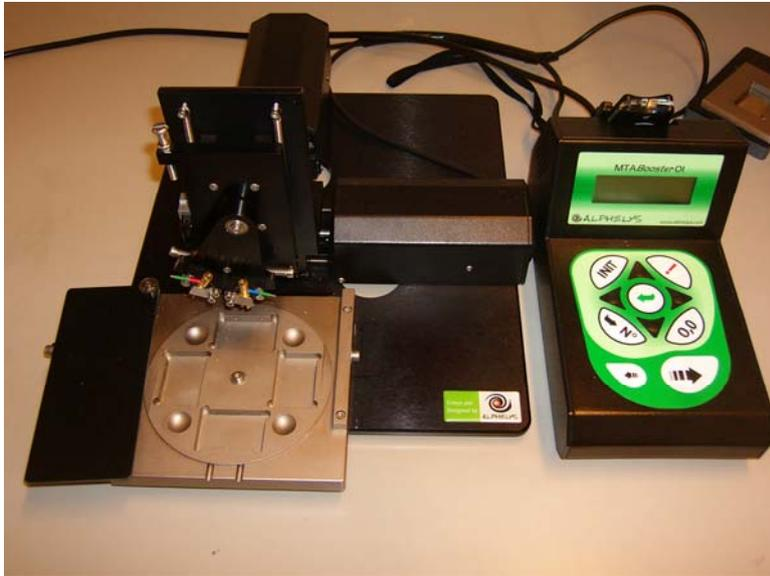
**Abbildung 1:** Manueller Tissue Arrayer mit TMA Booster Key und Halteapparat für den Leerblock
