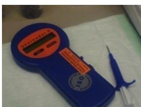
Abb. 4 Transponder-Lesegerät und Applikationsspritze für die Transponder
