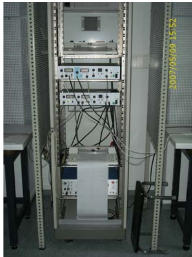
Abb. 11: Geräte außerhalb des Faraday-Käfigs Voltage-Clamp-Verstärker, darunter der 2-Kanal-Schreiber.
