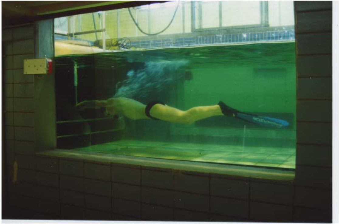
Bild 1: Passives Schleppen im Strömungskanal. Proband B Sporasub Dessault. Seitenansicht durch das Sichtfenster des Strömungskanals. Der Proband hält sich am Kraftaufnehmer fest.
