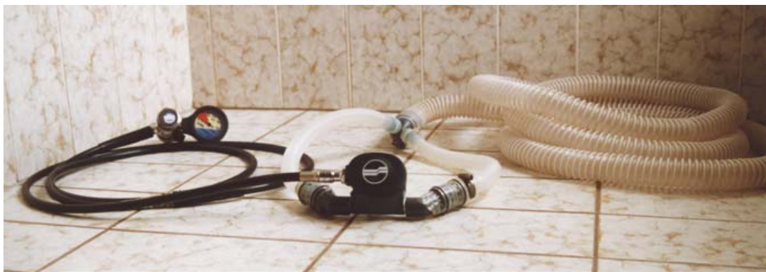
Bild 6: Der Atemregler Sherwood New Brut mit umgebungsdruckgesteuertem Ausatemventil. Links ist die 1. Stufe mit Manometer und Mitteldruckschlauch zur 2. Stufe. Die umgebungsdruckgesteuerten Ausatemventile sind mit Winkelstücken an der 2. Stufe angebracht. Die daran befestigten Schläuche werden (hinter dem Kopf des Probanden) zusammengeführt und die Ausatemluft über den Schlauch (rechts) zum Analysegerät abgeleitet.
