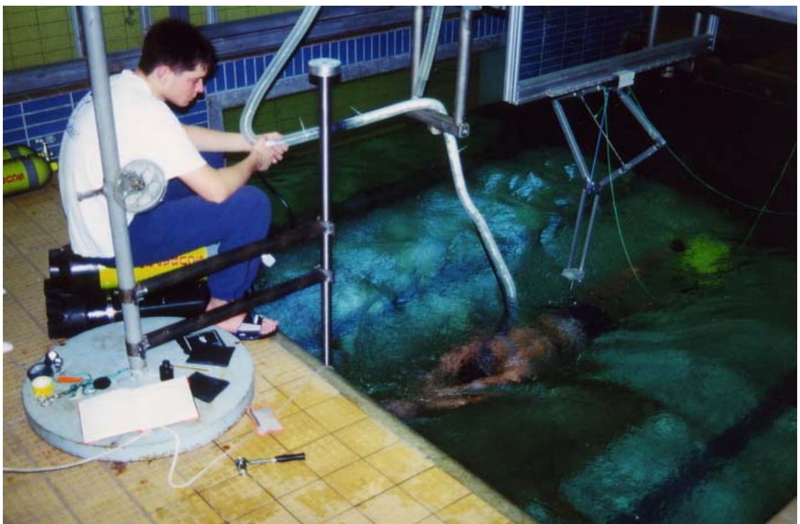
Bild 4: Gasanalytik. Proband B mit Seemann Sub SF 2. Sicht aus Strömungsrichtung. Links befindet sich die Sicherungsperson, welche die Schläuche zur Luftzuführung und Gasableitung kontrolliert. Der Proband ist in der in allen Ebenen frei beweglichen Aufhängung eingehängt.
