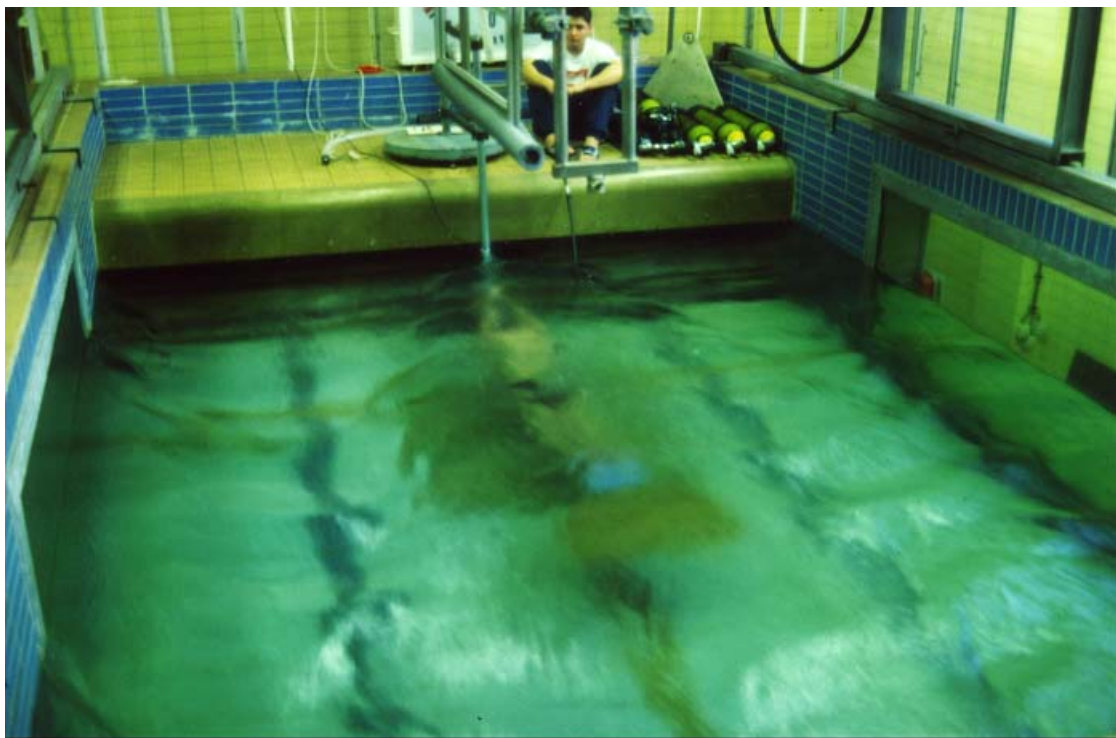
Bild 2: Passives Schleppen im Strömungskanal. Proband B Monoflosse. Sicht gegen die Strömung. Der Proband hält sich am Kraftaufnehmer fest. Rechts neben der Sicherungsperson liegen die Druckluftflaschen mit dem Luftvorrat.
