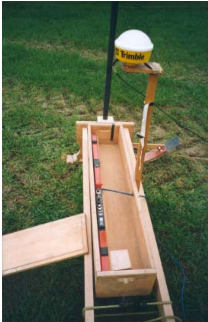
Abb. 26: Messanordnung für die Kartierung der elektrischen Leitfähigkeit (EM-38, ATB-Bornim e. V.)
