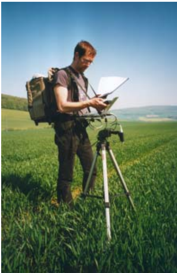
Abb. 34: Messanordnung und Durchführung der in situ Messungen (ASD FieldSpec ® Pro)
