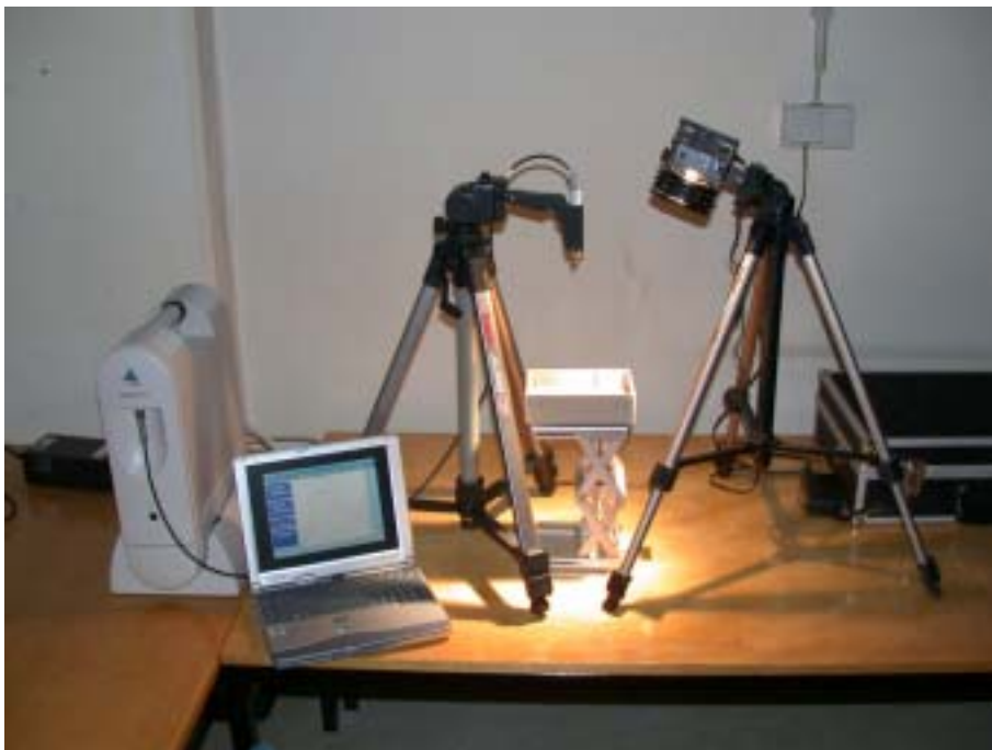
Abb. 35: Versuchsaufbau für die Labormessungen mit dem ASD FieldSpec® Pro
