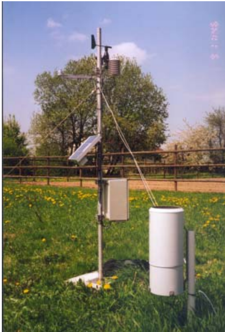
Abb. 29: Aufbau der Klimaloggerstation im Untersuchungsgebiet Imbshausen
