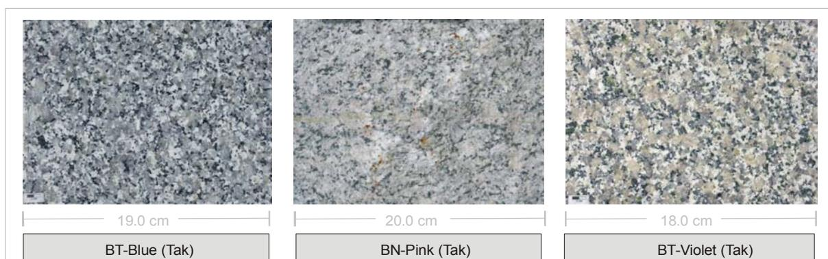
Abb. 4.1: Richtungslos-körnige Granitoide mit inequigranularem Korngefüge. Die Gesteine definieren sich makroskopisch lediglich über eine differenzierte Farbgebung der Feldspäte. Siehe hierzu auch die entsprechenden Datenblätter in Anhang II.
