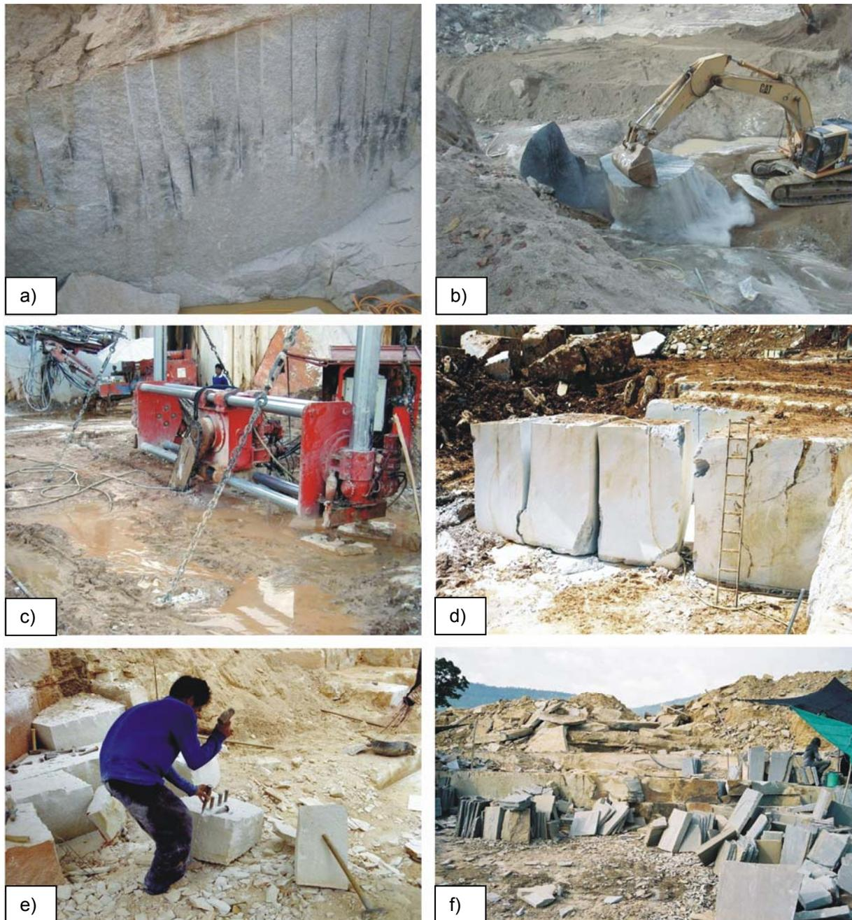
Abb. 2.5: a) Oberflächennaher Granitabbau durch kontrollierte Bohrlochspaltungen (Tak Granite Mining Co., Tak), b) Handling von abgesprengtem Bouldermaterial (Silamane Co., Tak), c) Moderne Abbautechnik in Marmorbrüchen (Sawang Marble Co., Kamphaeng Phet), d) Aus dem Gesteinsverband gesägte Marmorblöcke (Khao Yai Tachang Marble Co., Nakhon Ratchasima), e) Manuelles Spalten von Sandsteinen (Nakhon Ratchasima), f) Spaltrauhe, grüne Sandsteinplatten (Nakhon Ratchasima).
