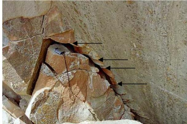
Abb. 7.47: Scharfkantige, muschelige Absplitterungen des weißen Sandsteins (Pfeile) im Einflussbereich einer Störungszone. Erläuterungen im Text dieses Kapitels.
