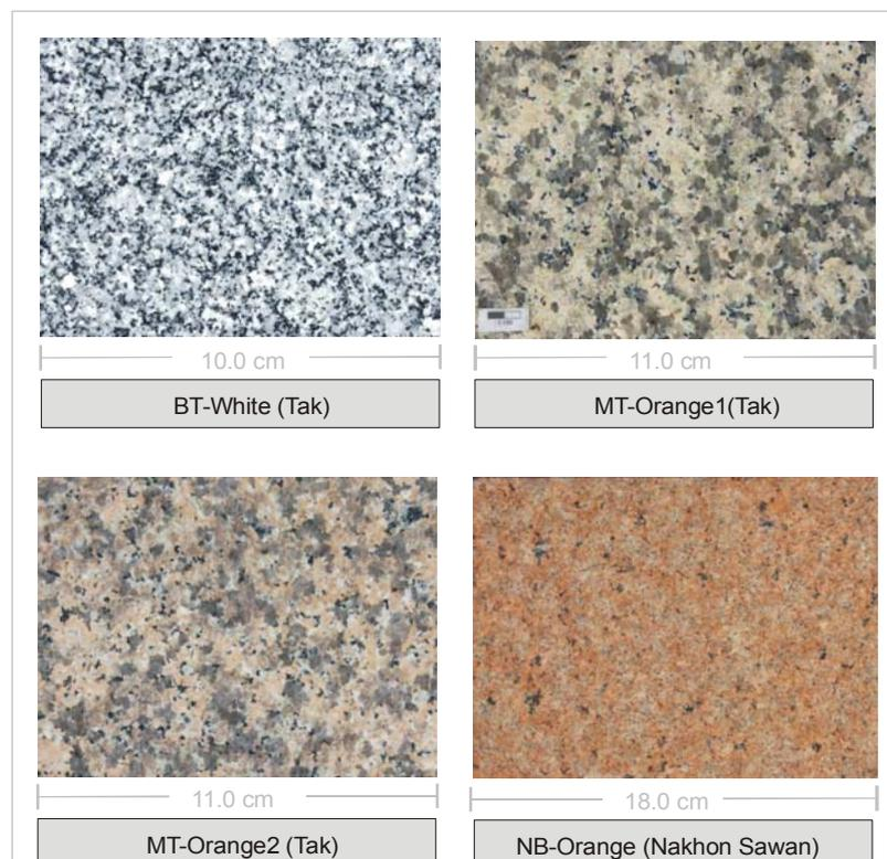
Abb. 4.2: Richtungslos-körnige Granitoide mit equigranularer Kornstruktur und hellgrauen bzw. orangen Grundtönen. Siehe hierzu auch die entsprechenden Datenblätter in Anhang II.
