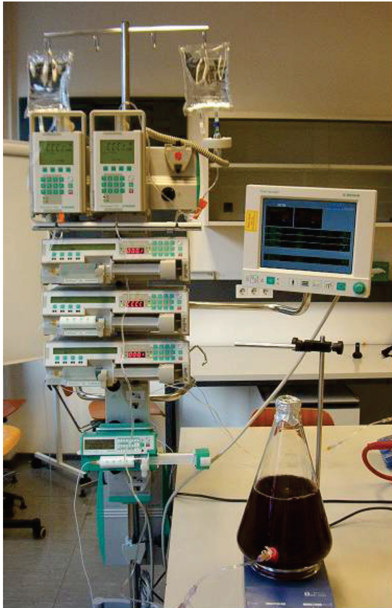
Abbildung 6: Der Gesamtaufbau des Versuches mit den Geräten fm computer (Monitor), fm controller mit Infusomaten und Perfusoren sowie dem „Patientenmodell“ (unten rechts)
