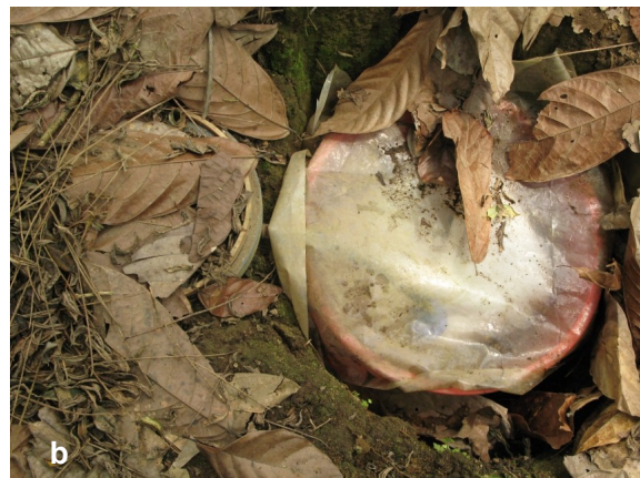
Abbildung 13 a+b Aufbau eines O-Lysimeters und Feldinstallation im Kakao-Agroforst mit 10-Literkanister als Wasserreservoir
