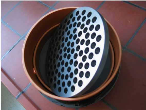
Abbildung 11 Innenansicht eines Ah- bzw. Bv-Lysimeters
