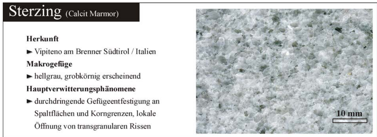
Abb. 4.5: Merkmale und makroskopisches Erscheinungsbild der untersuchten verwitterten Probe aus Sterzinger Marmor (Anschliff).
