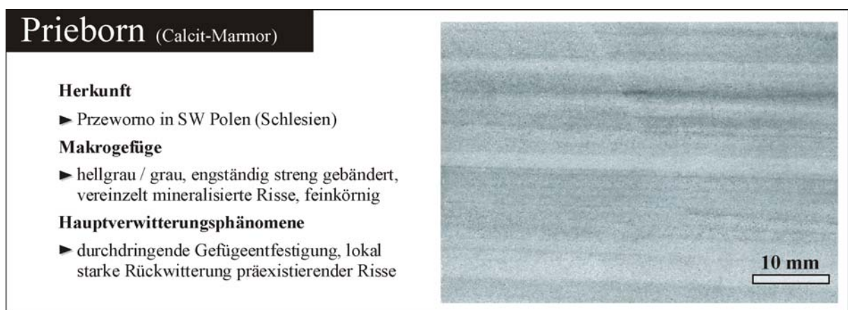
Abb. 4.2: Merkmale und makroskopisches Erscheinungsbild der untersuchten verwitterten Probe aus Prieborner Marmor (Anschliff).
