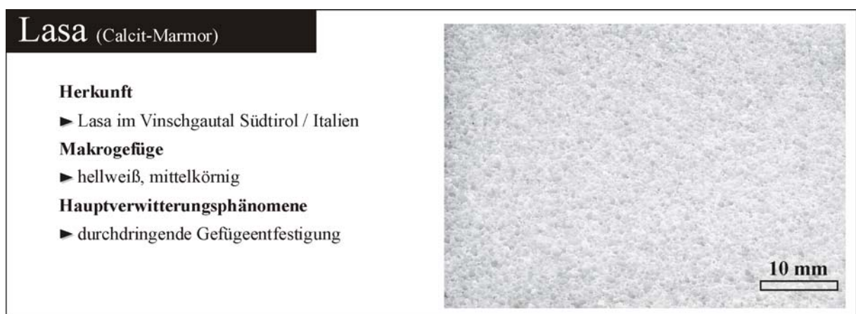
Abb. 4.3: Merkmale und makroskopisches Erscheinungsbild der untersuchten verwitterten Probe aus Lasa Marmor (Anschliff).
