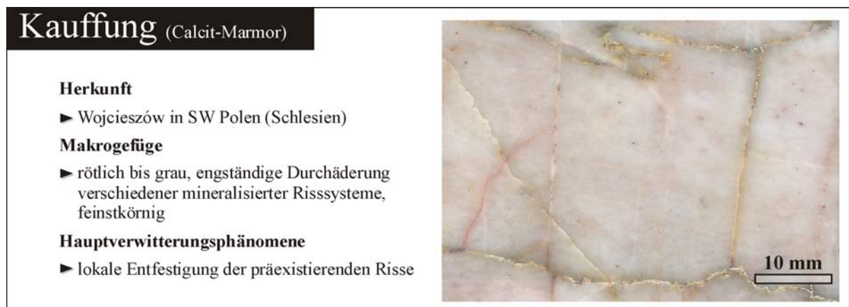
Abb. 4.6: Merkmale und makroskopisches Erscheinungsbild der untersuchten verwitterten Probe aus Kauffunger Marmor (Anschliff).
