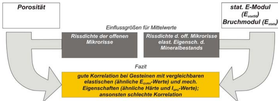
Porosität vs. statischer (bei 50% Bruchlast) E-Modul und Bruchmodul.
