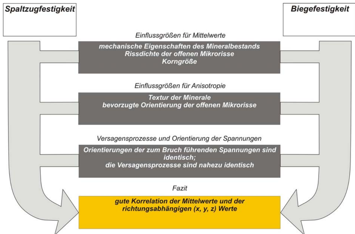
Abb.9-6: Spaltzugfestigkeit vs. Biegefestigkeit. Weitere Korrelationsdiagramme in Anhang III .
